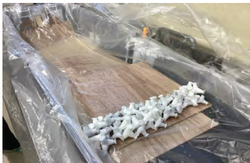
予備実験で使用した消波ブロック 本実験で使用した消波ブロック
